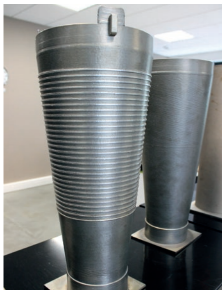
Foto oben: Testbauteile von Triebwerks- düsen für die Luftfahrt in Inconel 625.
