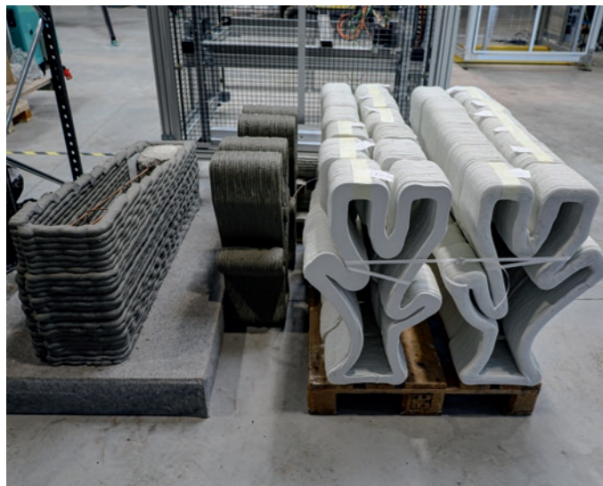
Der 3D-Druck mit Beton beschränkt sich nicht nur auf den Hausbau – auch Segmente für die Innenarchitektur sind möglich (links). Für zusätzliche Stabilität sorgt eine Verstärkung mit Baustahl (r.).
