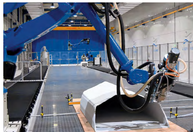
Auf der weltgrößten robotergestützten 3D-Druckanlage »MEGA II« produziert Al Seer Marine Boote aus Verbundmaterial
