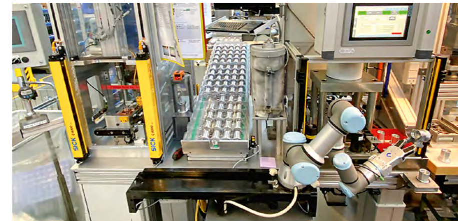
Foto oben: Viel 3D-Druck auf wenig Raum: Für diese Produktionsstation wurde eine gesamte Kugellagereinspeisemaschine, der 40cm große Rahmen einer Inspektionsstation und eine Abstellplattform aus PA12 gedruckt sowie ein Greifer aus Titan. Foto unten: Tausend echte 3D-gedruckte Produktmodelle aus Kunststoff können problemlos zu Messeauftritten mitgenommen werden
