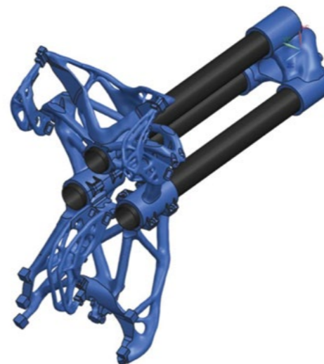
Foto oben: Durch sein geringeres Gewicht kann allein ein 3D-gedrucktes Bracket im Vergleich zu einem konventionell gefertigten (und designten) den CO 2 -Verbrauch eines Flugzeugs um mehr als 43 Tonnen senken
